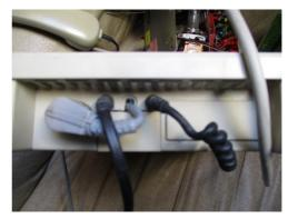
Als hätten die Designer es geahnt: das Modemkabel kann über die dritte Kabel-Aussparung wieder ins Gehäuse zurückgeführt werden.
