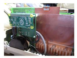
In einen noch freien Steckplatz schnell einen Rest Plexiglas eingearbeitet und 4 Abstandshalter montiert (alles aus Kunststoff). Da die Lochbohrungen etwas kleiner 3mm sind, wird das Modul einfach aufgedrückt, hält super.
