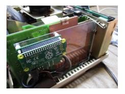
Der Befestigungsort sollte frei sein von Abschirmblechen, um Wlan zu ermöglichen.
