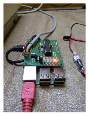
Es gibt nur noch das Netzwerkkabel und die Verbindung zum Terminal. Sobald das Netzteil des Terminals Spannung liefert, startet der Bootvorgang des Pi. Hiermit wird der Optpkopplereinsatz etwas ad absurdum geführt, schützt aber weiterhin die Ports.
