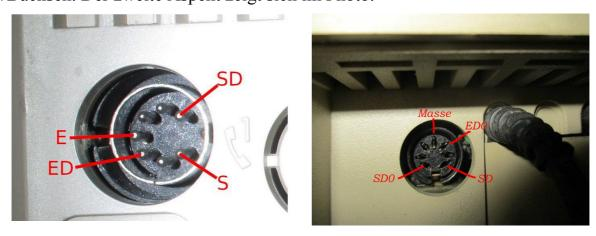
Links das Bild des Entwicklers, rechts das Bild meines Terminals, wie es sein muss um zu funktionieren. Es ist richtigerweise gespiegelt, kann man aber nicht unbedingt vorraussetzten wenn schon Stecker oder Buchse am Terminal verbaut werden. Hat natürlich nicht sofort geklappt. Auch der Platinenaufdruck scheint sich am Einbaustecker zu orientieren.
